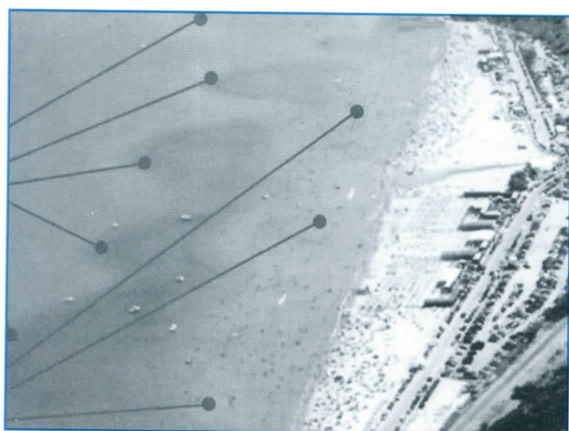
■ Foto aerea di una spiaggia di buche qualche giorno dopo una mareggiata. Le parti scure del fondale sono buche scavate dalla corrente di risacca. Le parti chiare sottocosta sono banchi di sabbia.
